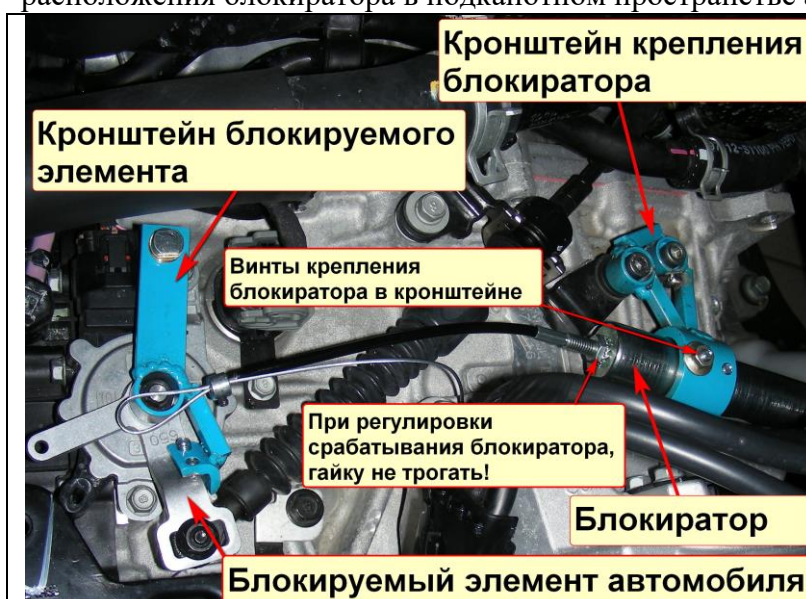
Рис. 4. Пример расположения блокиратора под капотом автомобиля
